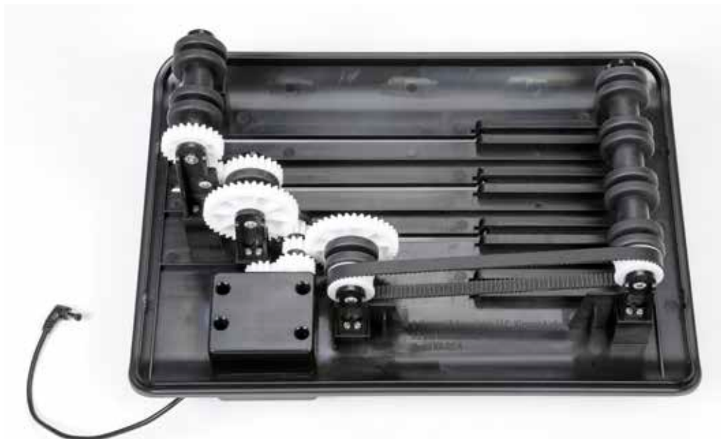
Auf der Unterseite des Plattenaufnehmers sitzt die motorbetriebene Mechanik, die die Scheiben in gemächlichem Tempo durchs Wasserbad dreht.
